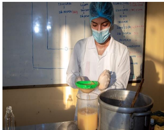
Anexo 20 Etapa de tamizado de bebida para envasado.
