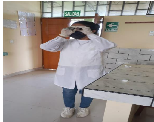
Anexo 25 Medición de °Brix de muestras obtenidas.
