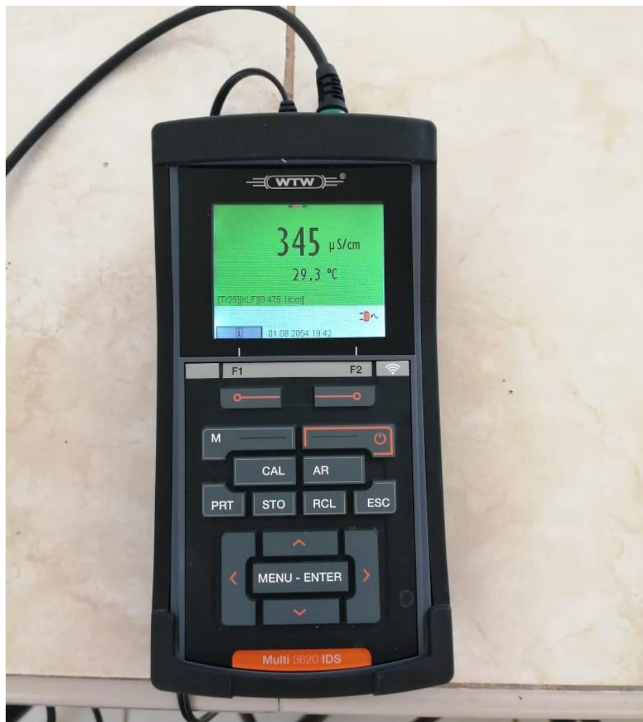
Anexos 8 . Resultados de la conductividad eléctrica del agua de riego de la parcela ubicada en el CET.
