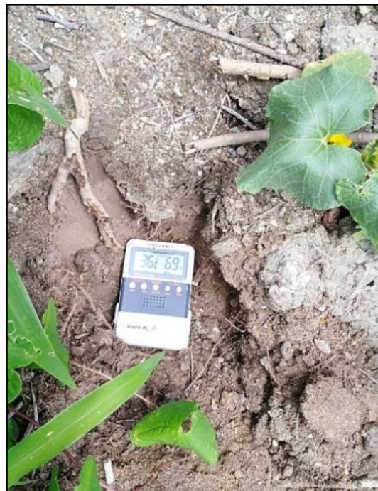
Figura 14: Medición de humedad relativa del suelo a profundidad de 15 cm.
