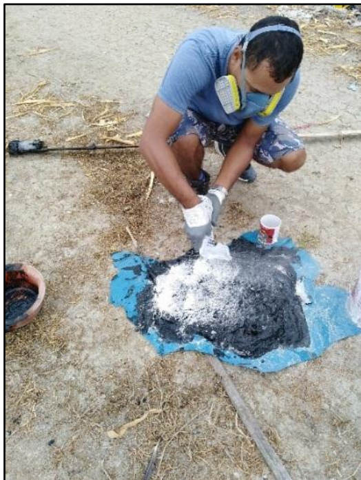
Figura 10: Aplicación de CAL para la estabilización del lodo crudo y así obtener biosólido para ser llevadas a laboratorio.
