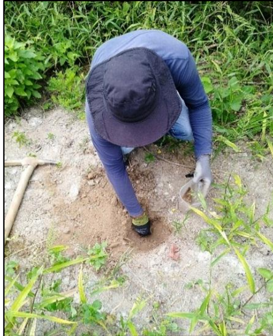
Figura 15: Toma de muestra de suelo en una calicata a 15 cm de profundidad.
