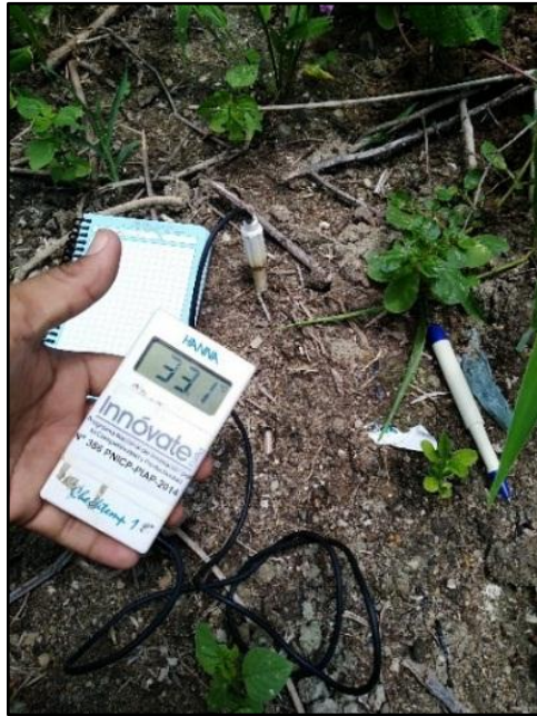
Figura 13: Medición de temperatura del suelo a nivel de superficie.
