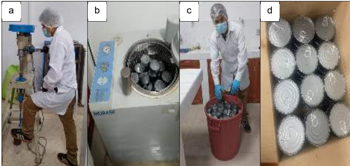
Figura 10. Etapas finales de elaboración de conservas. a) Cerrado de envases, b) Esterilización de conservas, c) Shock térmico y d) almacenado de conservas.
