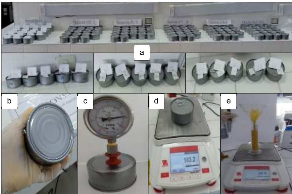
Figura 11. Análisis físicos de conservas enlatadas. a) Sorteo al azar de conservas enlatadas para los análisis correspondientes, b) Inspección visual de exterior de conservas enlatadas, c) control de vacío (in Hg) de conservas, d) Peso bruto de conservas y e) Peso del líquido de gobierno.
