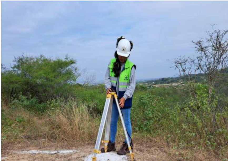
Figura 7. Armado y colocación de GPS y equipos en el punto de vuelo.
