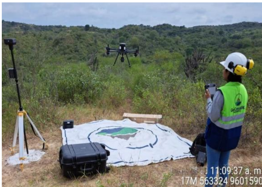
Figura 8. Vuelo LiDAR en la zona de estudio.
