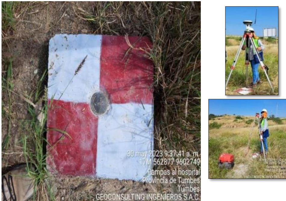
Figura 4. Lectura e instalación de equipos en el Punto de control TUM01219, tomado como partida.
