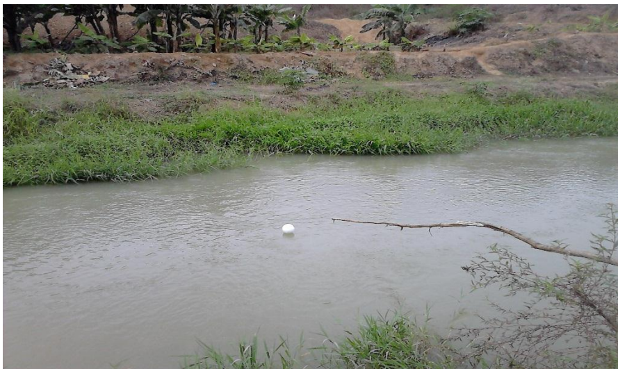
Foto 4. Aforando el Canal No Revestido utilizando el Método del Flotador
