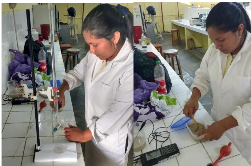
Figura 5. Análisis de acidez (izquierda) y medida del pH (derecha).
