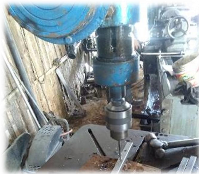
Foto 5. Perforación de 5/16" de los tubos galvanizados.
