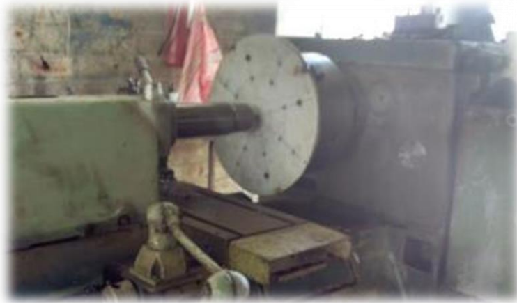
Foto 3. Perforación en las platinas en el torno.
