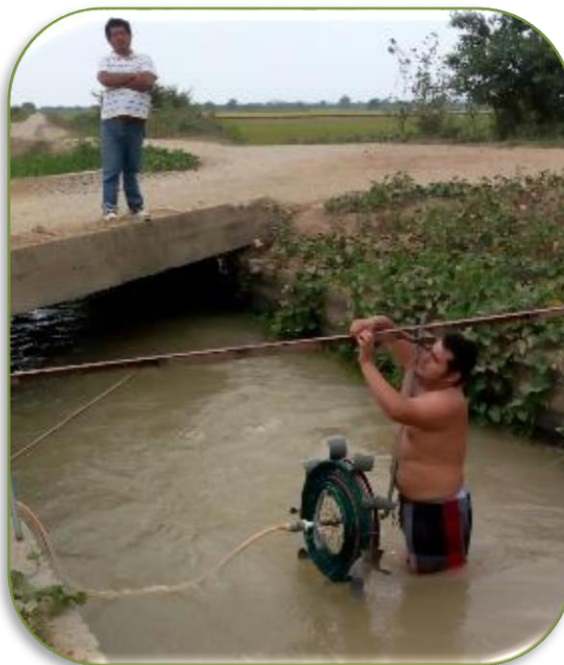
Foto 10. Ajuste del porcentaje de sumersión
