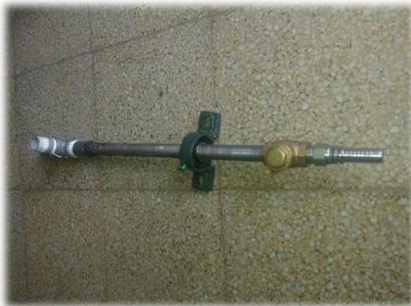
Foto 9. Articulación hidráulica de la bomba que trabaja como eje.
