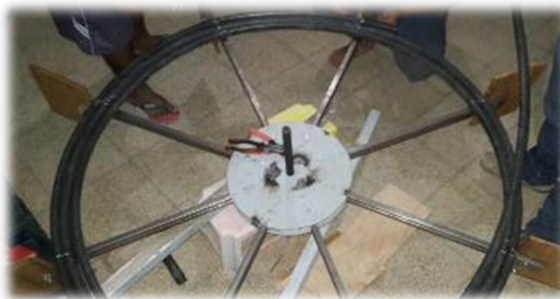
Foto 8. Se hacen las espiras con los 25 metros de la manguera de polietileno Fuente: Elaboración propia
