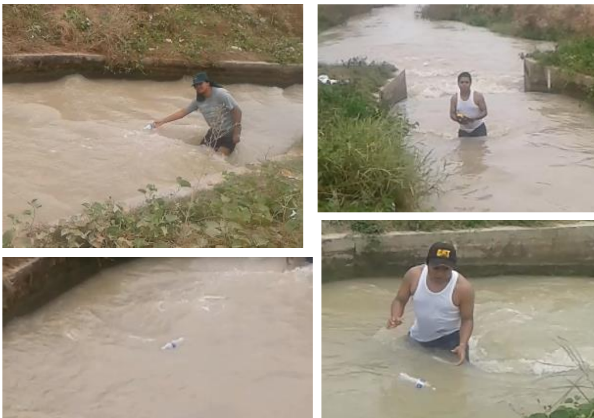
Foto 1. Fotografías del punto A y punto B, y el flotador utilizado en el canal de irrigación.
