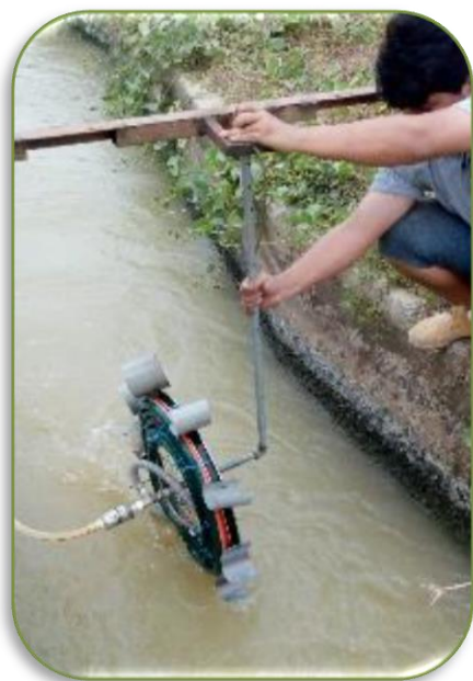
Foto 9. Colocación de la bomba de espiral en el canal.
