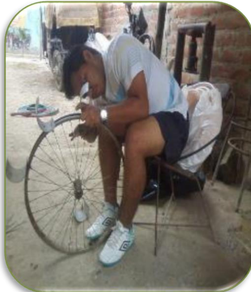
Foto 4. manguera puesta en la rueda en forma de espiral.
