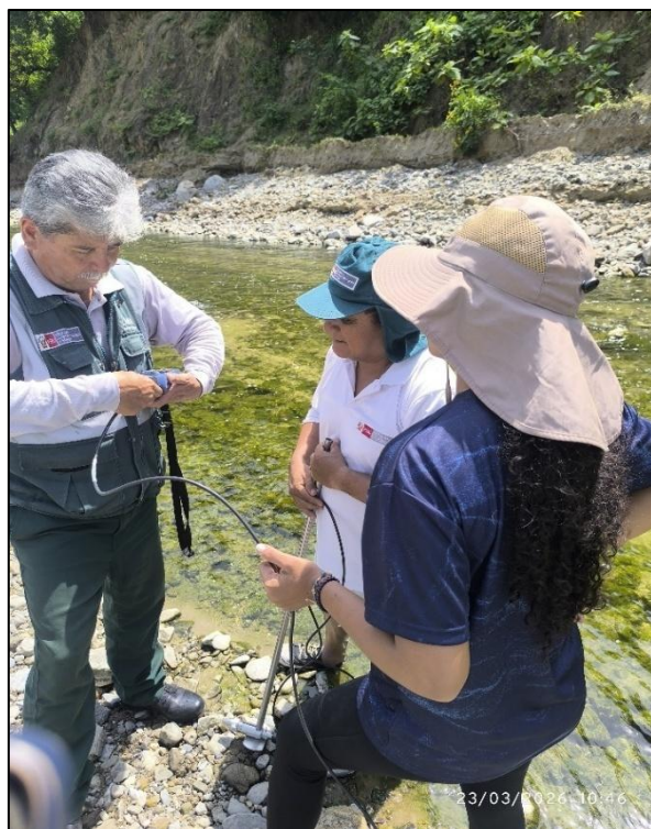
Anexo 4. Preparando el equipo para realizar el aforo en la Quebrada Cabuyal con apoyo profesional técnico del ANA.
