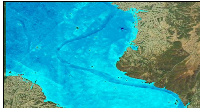
Figura 48: Modelamiento Hidráulico 2 D Tr = 50 años
