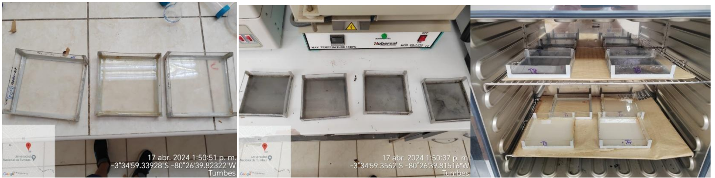
Foto 3.3. Plaqueo de recubrimientos y secado
