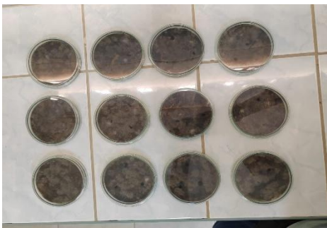
Foto 7.1. Sembrado en placas y colocación de película de quitosano
