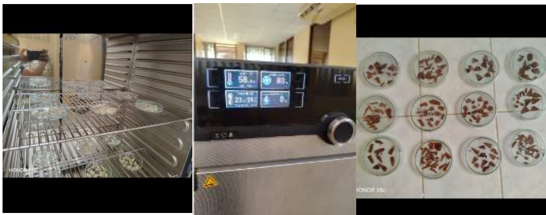
Foto 3.2. Medición de Humedad
