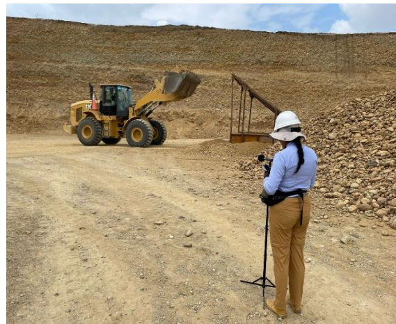
Foto Nº 50. Monitoreo de ruido ambiental en el tramo de intervencion de la quebrada La Jardina
