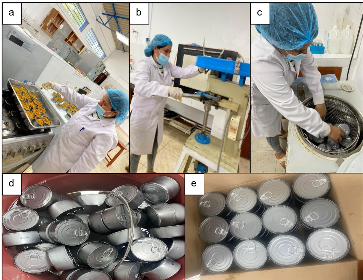
Figura 5. Etapas de procesamiento de conservas enlatadas: a) Adicionamiento de líquido de gobierno, b) Cerrado de envases de hojalata, c) Esterilización de conservas enlatadas, d) Golpe térmico de temperatura y e) Almacenado de producto terminado.
