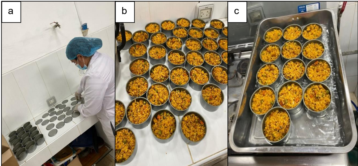
Figura 4. Preparación de conservas: a) Acondicionamiento de envases, b) Llenado de envases y c) Etapa de exhausting .
