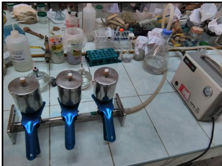
Foto N°06: Instalación de bomba generadora de vacío para la determinación de Coliformes Termotolerantes.
