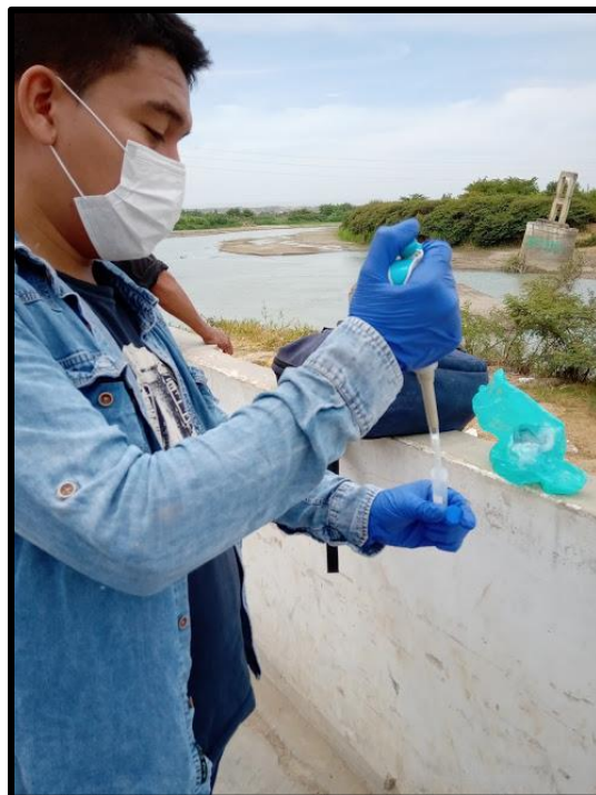
Foto N°02: Aplicación de ácido nítrico para la determinación de metales pesados.
