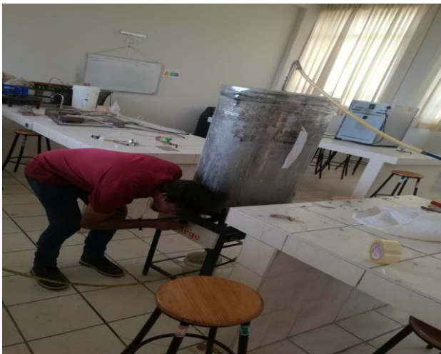
Anexo 1.4: Montaje del equipo para la extracción del aceite esencial por arrastre vapor con agua y proceso de extracción.
