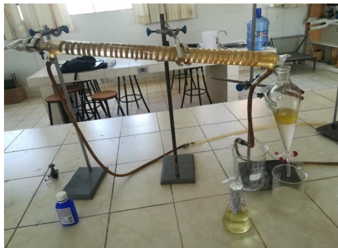
Anexo 1.4: Montaje del equipo para la extracción del aceite esencial por arrastre vapor con agua y proceso de extracción.
