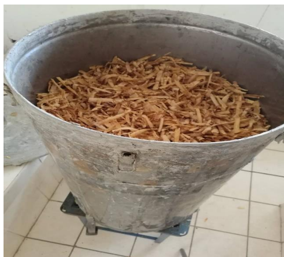
Anexo 1.3: Palo santo en viruta en la autoclave lista para la extracción del aceite
