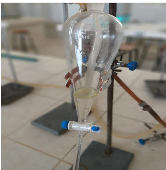
Anexo 1.5: Separación física del aceite esencial por diferencia de densidades.
