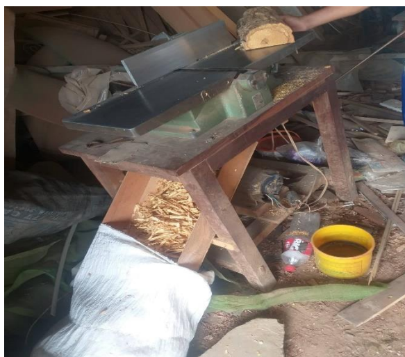
Anexo 1.2: Proceso de cortado en viruta del palo santo con cepilladora eléctrica.
