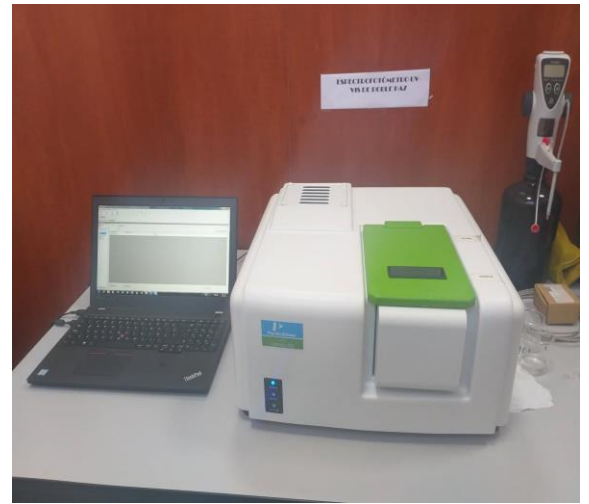
Anexo 1.8: Medición de la absorbancia utilizando espectro UV-VIS
