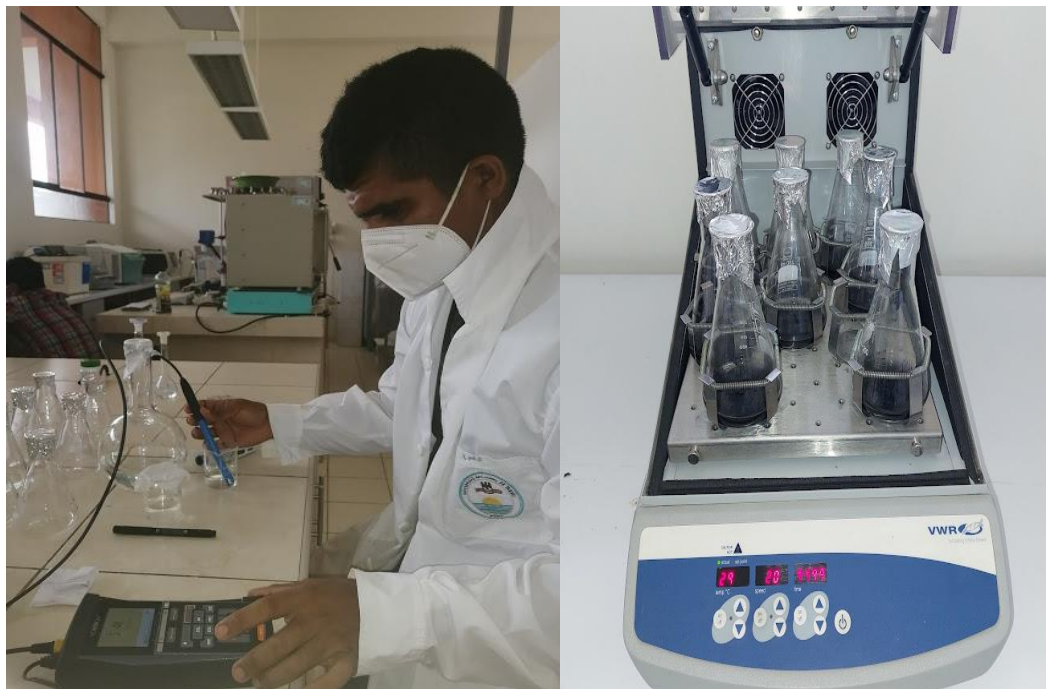
Anexo 28. Ajuste de pH en rangos de 3 hasta 10 para posteriormente determinar el pH de carga cero.
