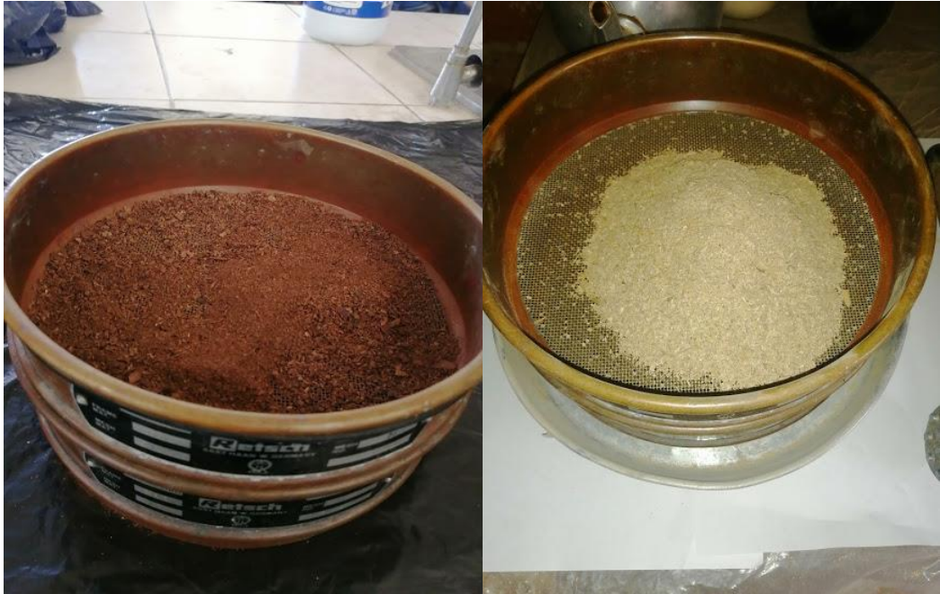
Anexo 21. Tamizado de materia prima a un diámetro de 1.5mm.
