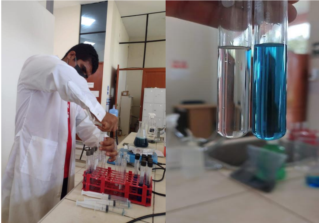
Anexo 31. Proceso de filtrado de muestras para realizar lectura en el espectrofotómetro uv-vis.
