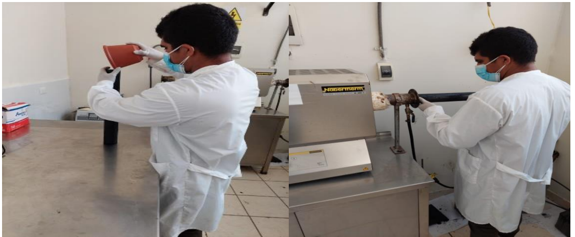
Anexo 22. Colocación de materia prima en horno tubular a una temperatura de 600°C por un periodo de 2 horas.
