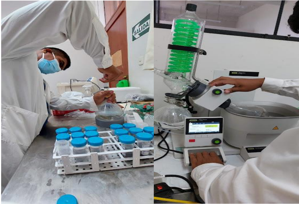
Anexo 33. Concentración de muestras en fase líquida, para posteriormente realizar su lectura en el analizador de espectros.
