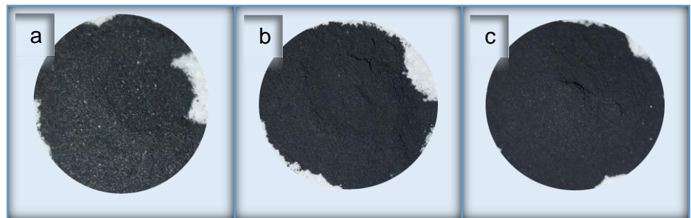
Figura 5. Materiales a base de cáscara de cacao después de ser sometidos a tratamiento hidrotermal, 5a) BC-TH-RB, 5b) CA-2M-TH-RB, 5c) CA-5M-TH-RB
