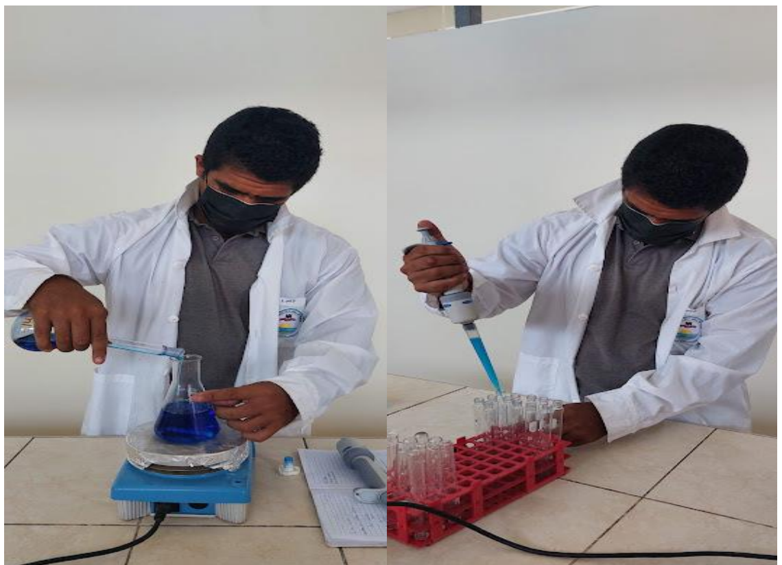
Anexo 30. Cinética de adsorción de azul de metileno 20ppm, con dosis de adsorbente de 0,5 g/L.
