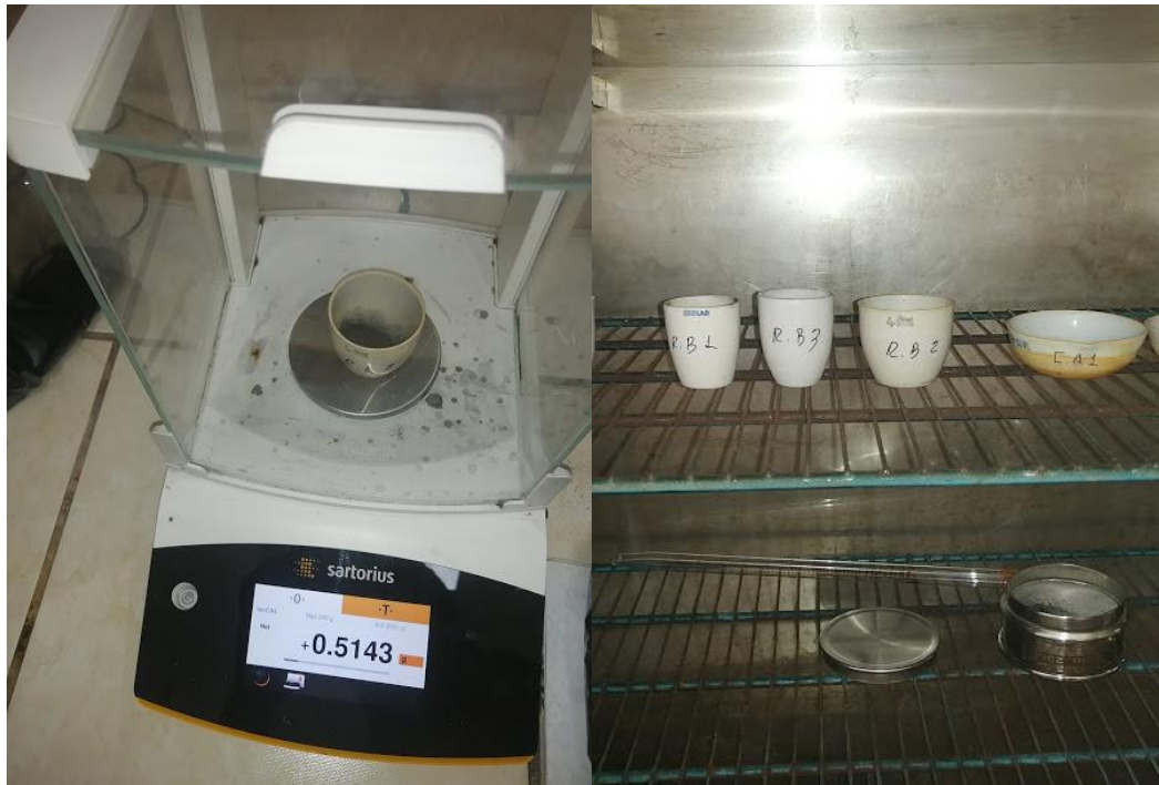
Anexo 27. Pesado y secado de material obtenido, para la determinación de su contenido de humedad y porcentaje de cenizas.
