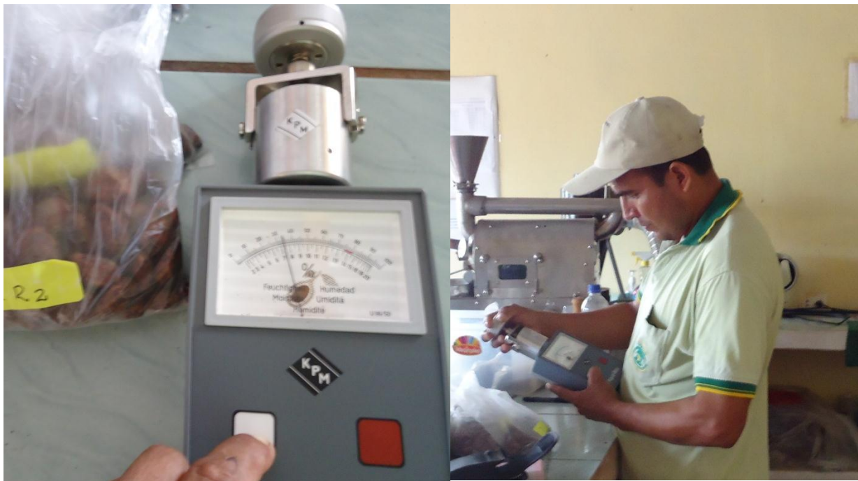
Figura 9 Medición de humedad con la ayuda de un higrómetro
