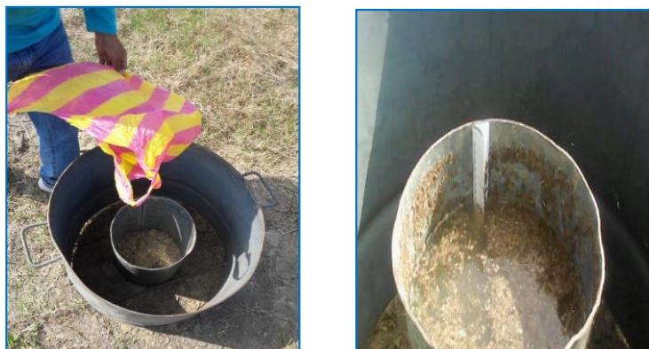
Foto 5: Pruebas de infiltración
