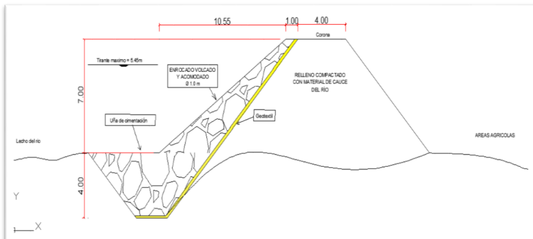
Figura 40.- Sección Típica a detalle del Dique
