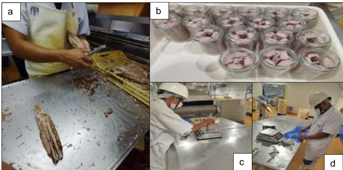
Figura 15. Etapas de fileteo y envasado de atún a) fileteo de atún precocido, b) envasado de filetes, c) pesado de atún en frascos de vidrio y d) pesado de espárragos y arvejas.
