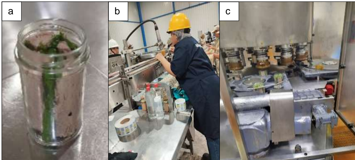
Figura 16. Envasado de conservas. a) envasado de conservas de atún con espárragos y arvejas, b) adición del líquido de gobierno y c) sellado de conservas.
