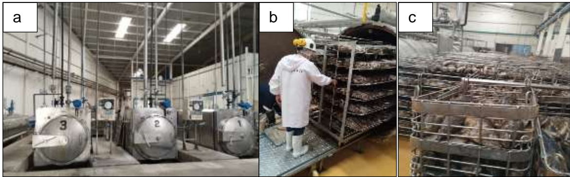
Figura 13. Cocinado de atún. a) cocinadores de pescado, b) entrada de carros o ches al cocinador y c) atún cocinado o pre-cocido.
