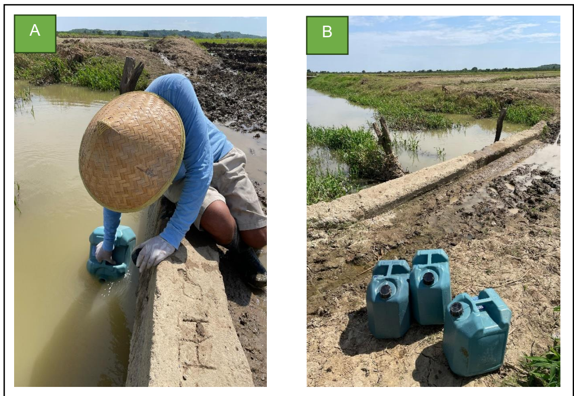
Figura 8. Recolección de agua residual proveniente del dren agrícola MI. (A) Llenado de un bidón de 20 L. (B) Almacenamiento de agua residual
