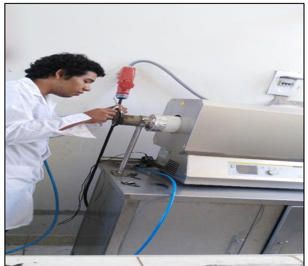
Foto N°08: Proceso de Carbonización, en el reactor acondicionado para la obtención de biocarbón.
