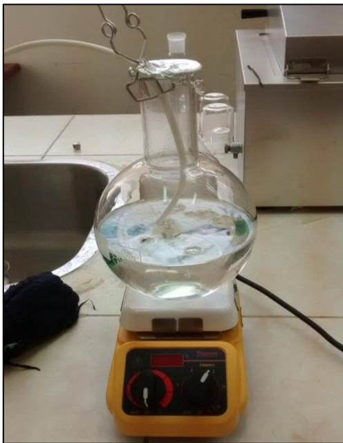
Foto N°11: saturación con gas nitrógeno para la eliminación de \text{CO}_2 atmosférico en la solución de pH carga cero.
