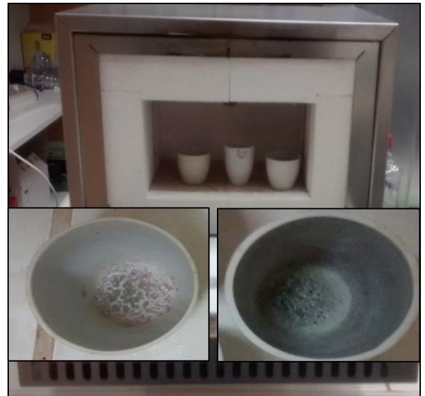
Foto N°10: equipo "mufla" que permite la incineración de los biocarbones en crisoles para determinar el contenido de cenizas.
