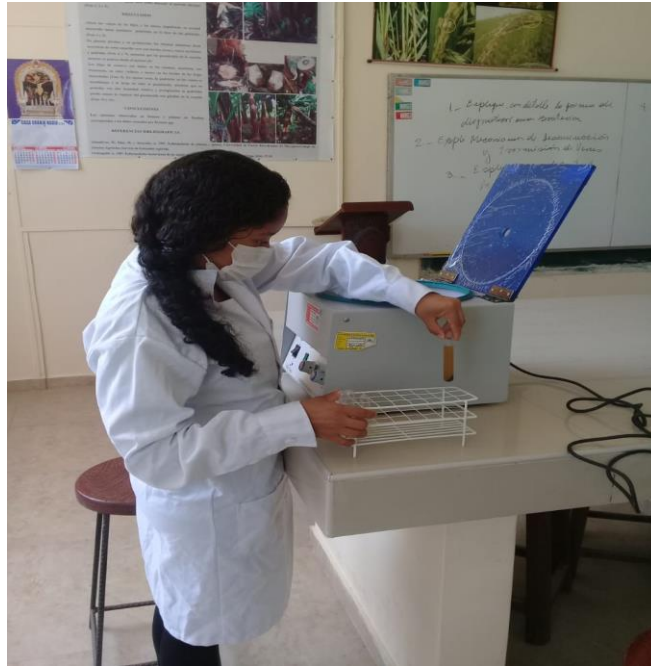
FIGURA 10: Centrifugado de las muestras
