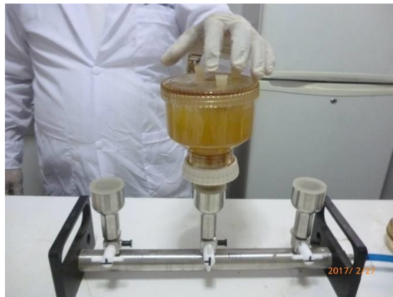
Equipo de filtración de agua
