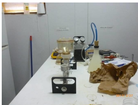
Equipo de filtración de agua
