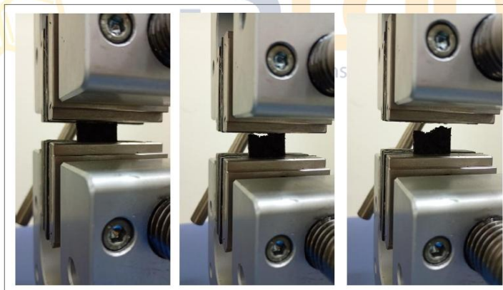
Imagen N°03: ANTES DE RUPTURA / DURANTE LA RUPTURA / DEPUÉS DE RUPTURA (S-3434)
