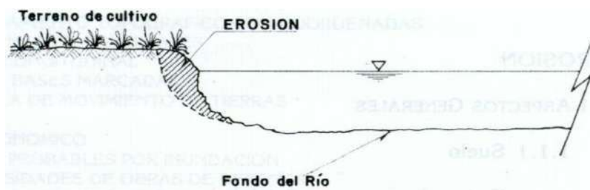
Fig. 5: Mecanismo de la erosión por agua
