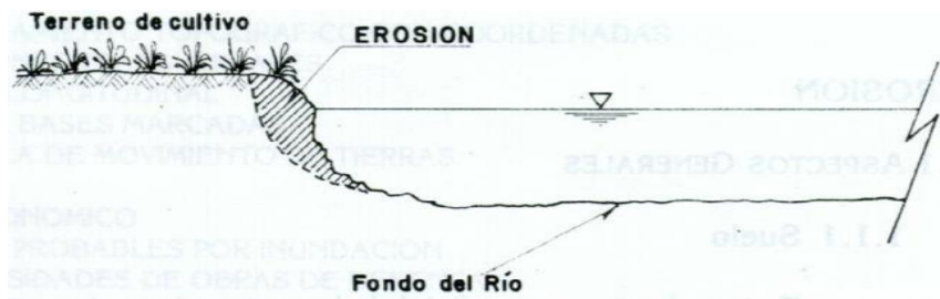
Fig. 6: Mecanismo de la erosión por agua
