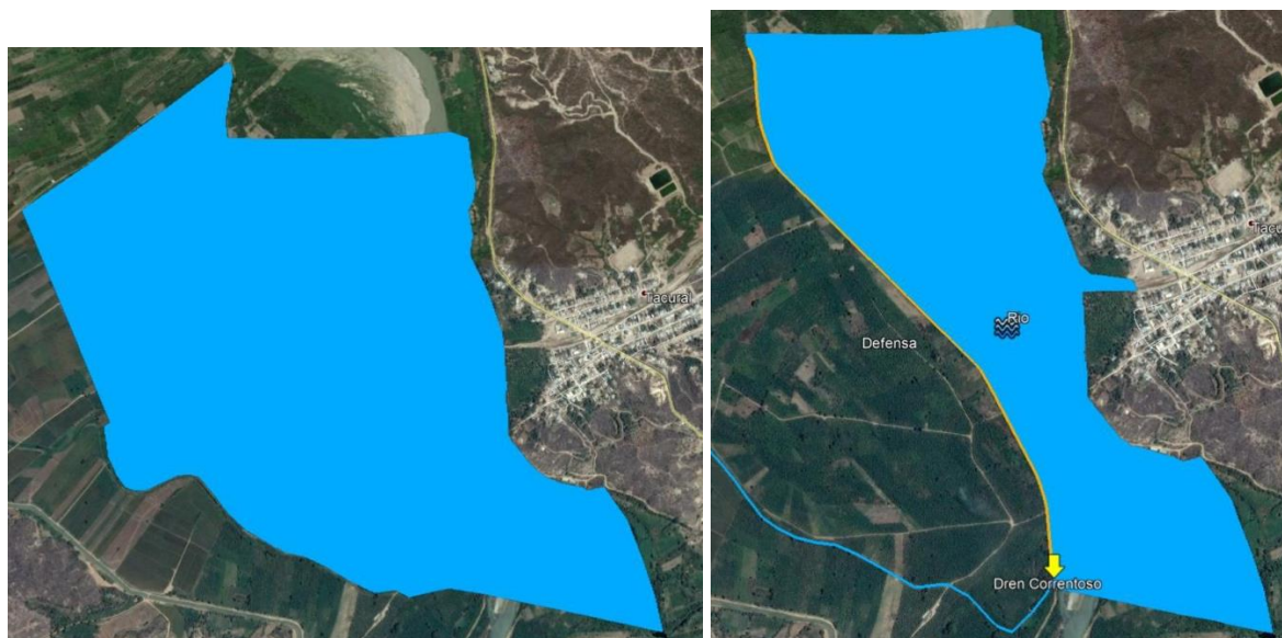
Figura N° 23: Imágenes de comparación de áreas del cauce del río y áreas inundadas, sin defensa (319 Has) y con la defensa ribereña incorporada (131 Has).
