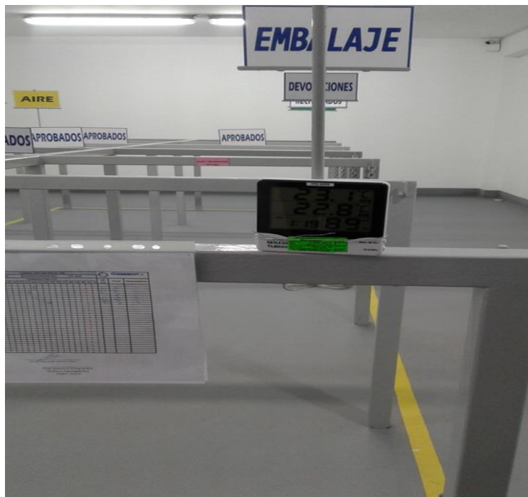
Fotografía 2: Almacén de Droguería de Gases Medicinales: control constante de temperatura (T) y humedad relativa (HR)
