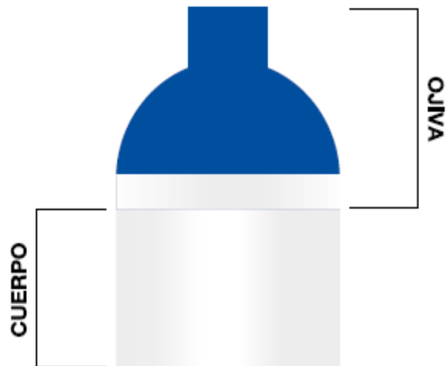
Figura 2: Partes de un cilindro de gas medicinal
