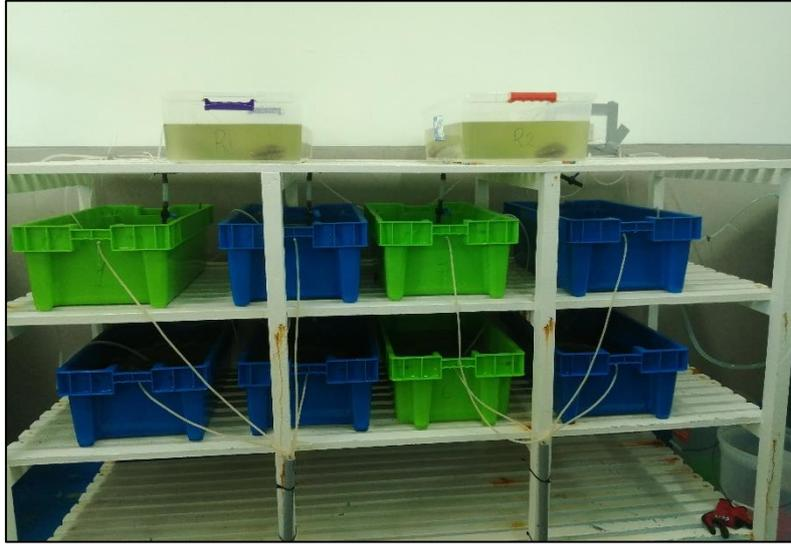
Figura 5. Sistema de aclimatación a flujo abierto para los ejemplares de conchas de abanico.
