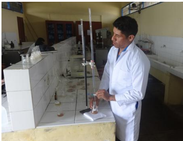
Figura 7. Titulación de las muestras de filete de tollo salado en el análisis de cloruro de sodio.
