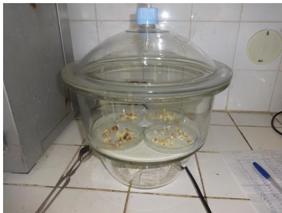
Figura 6. Muestras de filete de tollo salado enfriándose en la campana desecadora para el análisis de humedad.
