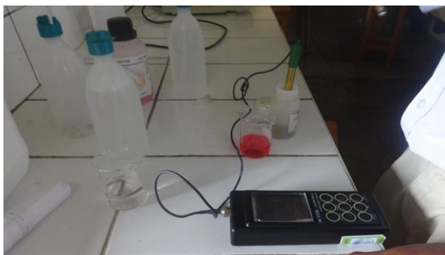
Figura 8. Calibración del pH-metro para determinación del pH de las muestras de filete de tollo salado.
