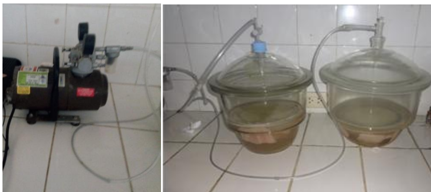
Figura 5. Bomba de presión/vacío y campanas de desecación con salmuera sobresaturada para el salado por deshidratación osmótica a vacío de filetes de Mustelus dorsalis .
