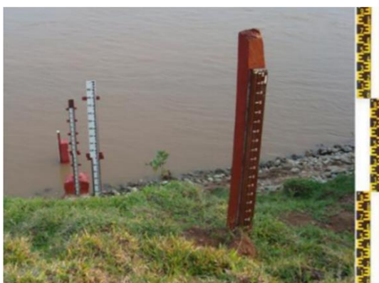
Figura 2. Reglas limnimétricas instaladas en el curso del río
