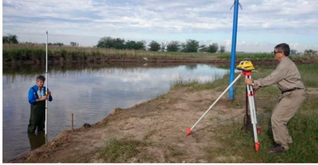
Figura 3. Medición de caudal en una estación limnigráfica
