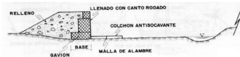
Figura 3: Defensa Ribereña Permanente tipo Gaviones
