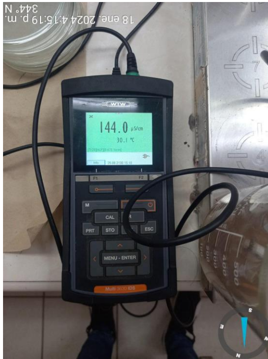
Figura 7. Medición de conductividad eléctrica.
