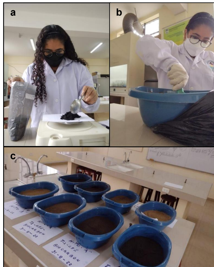
Figura 8. a) Pesaje de la muestra de Biocarbón b) Homogenización de Biocarbón y suelo forestal c) Tratamientos.
