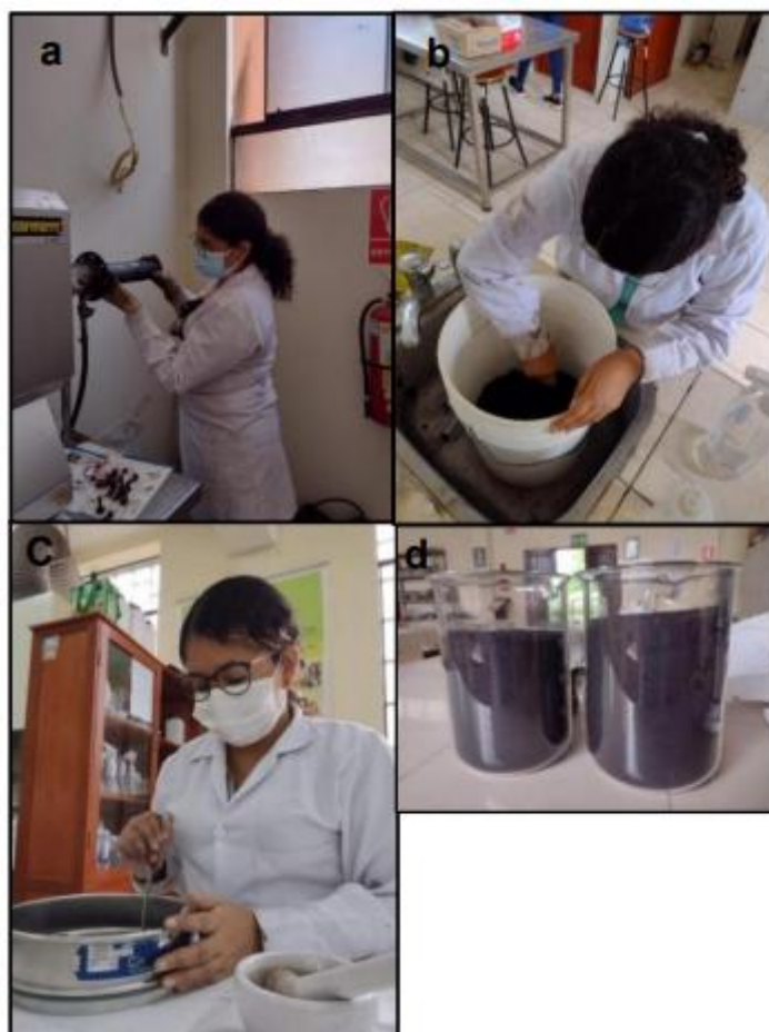
Figura 4. a) Ingreso de materia prima en el horno tabular b) Lavado de biocarbón con agua destilada caliente c) Tamizado de biocarbón d) Biocarbón tamizado.
