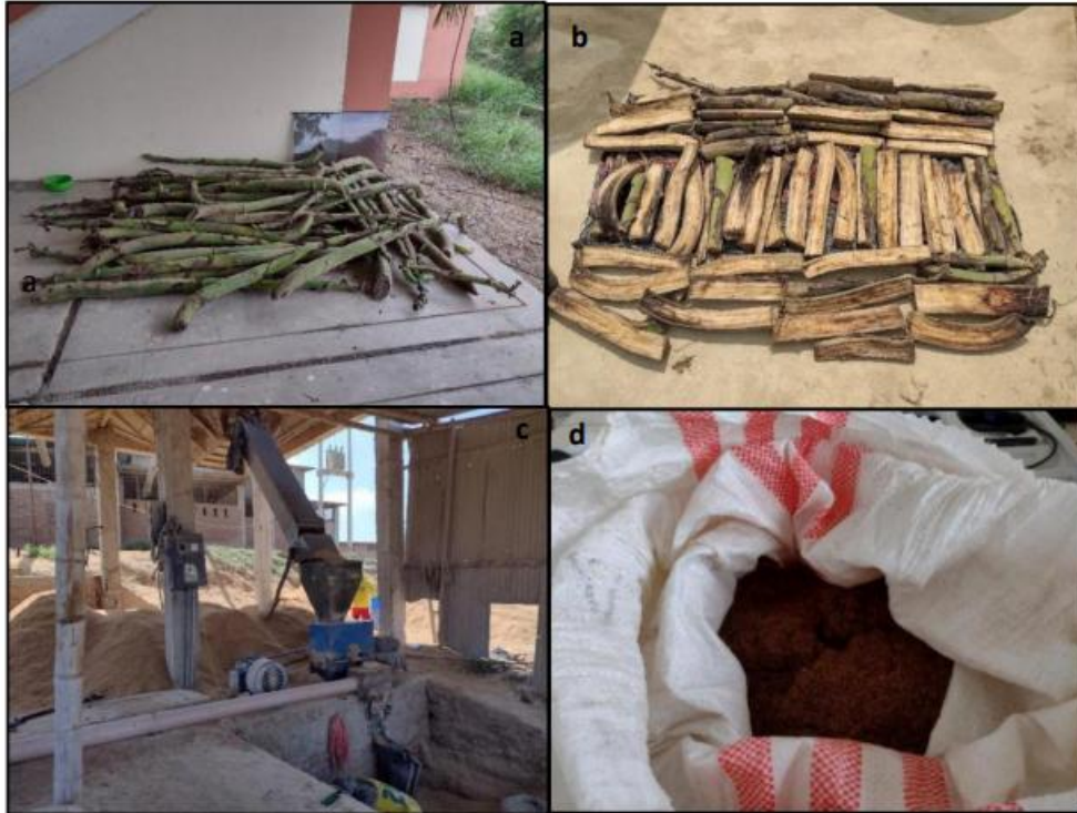
Figura 3. a) Materia Prima b) Secado de Materia Prima a Temperatura Ambiente c) Molino Triturador d) Materia Prima Molida.
