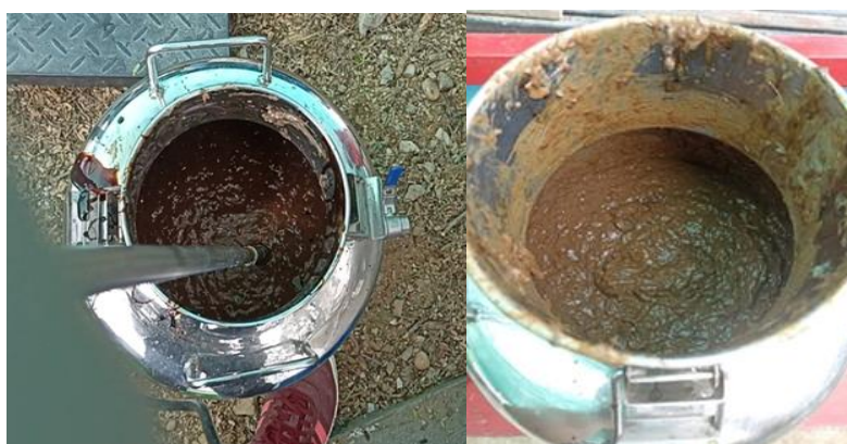
Figura 8. Mezclador eléctrico y el resultado de la homogenización.
