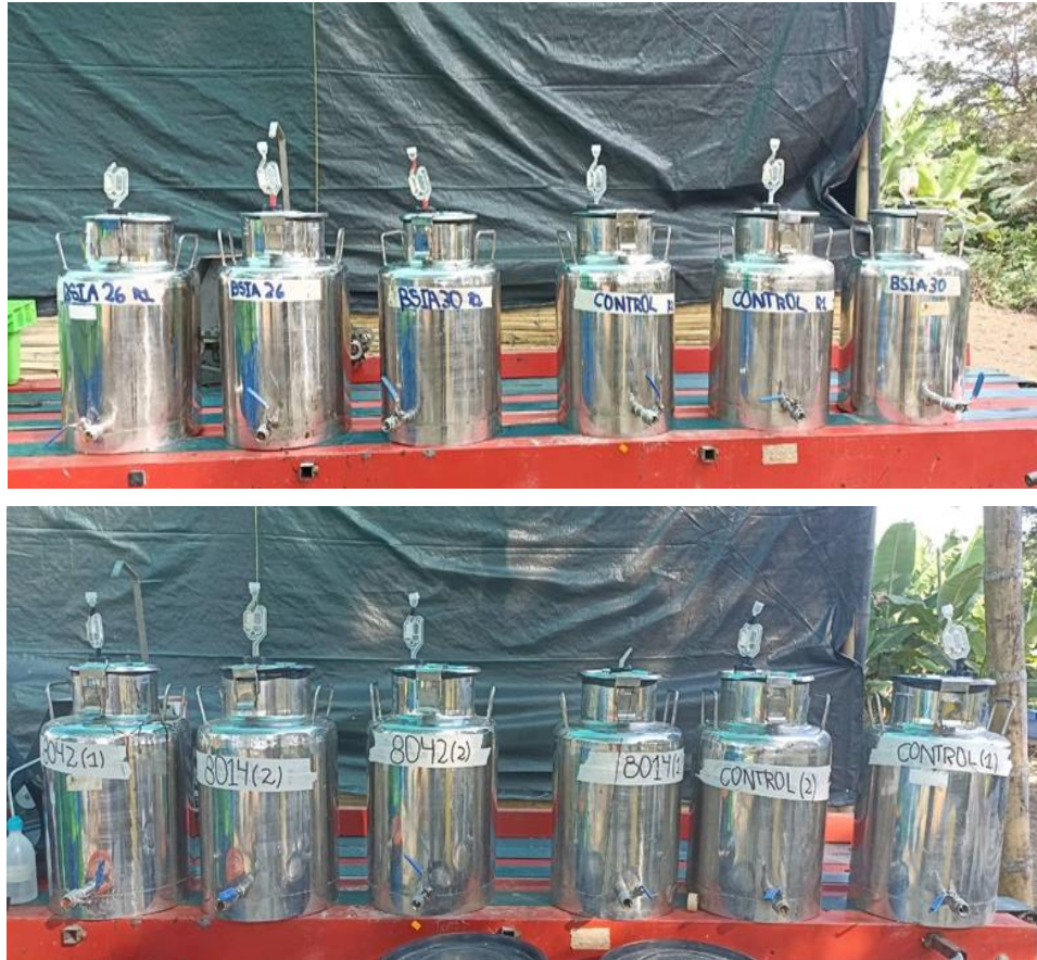
Figura 9. Fermentadores utilizados en el proceso de biofermentación de los residuos de pescado con inóculos nativos y comerciales.
