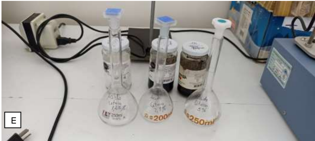
E) Hidrocarbon de moringa en estado liquido obtenido luego de la mordificacion con acido cítrico y tratamiento hidrotermal
