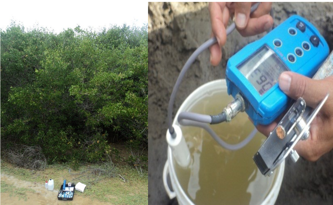
Figura 33: Equipo multiparámetros y un potenciómetro para medir condiciones ambientales del bosque del manglar de Puerto Pizarro (Tumbes).
