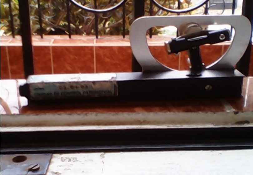
Figura 32: Clinómetro para medir altura del árbol del bosque del manglar de Puerto Pizarro (Tumbes).
