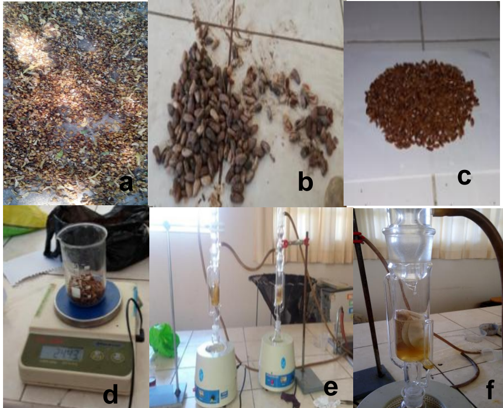
Figura 2: Extracción del aceite del neem método soxhlet; a) semilla, b) semilla seleccionada, c) semilla sin cascara, d) peso de semilla, e) equipo soxhlet, f) balón del soxhlet.
