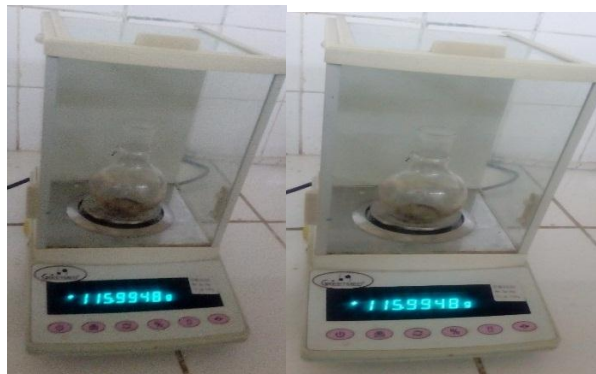
Foto D.1: Pesado inicial del balón de fondo plano y de las muestras
