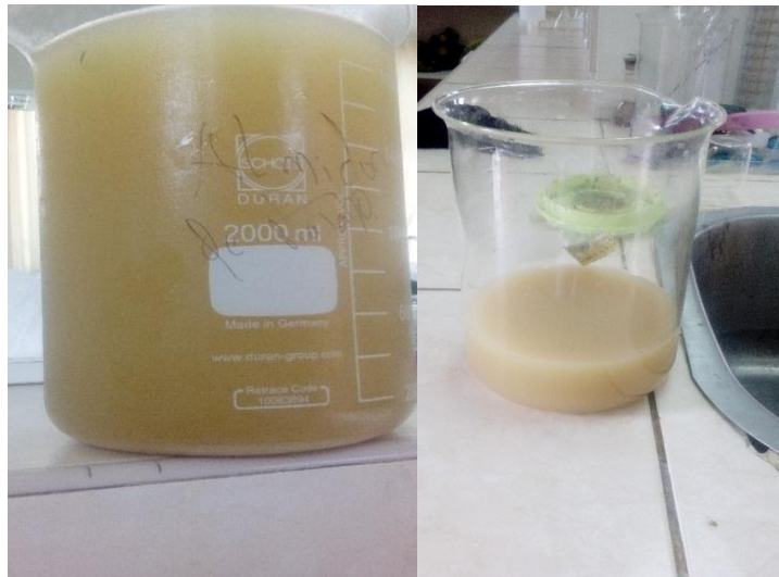
Foto A.3: Extracción del almidón de la mezcla por varios licuados con bisulfito de sodio y agua a través de filtración
