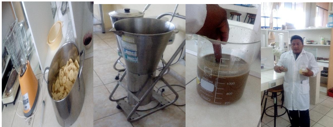
Foto A.2: Adición de S_2O_5 al 0.5% a la materia prima y licuado
