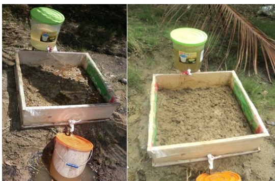
Figura 9. Mejora en las características de color del suelo del manglar. A la izquierda se aprecia un cajón conteniendo suelo con evidente presencia de hidrocarburos al inicio de la biorremediación. A la derecha se aprecia el mismo cajón al finalizar la misma, mostrándose un terreno aparentemente sin hidrocarburos.
