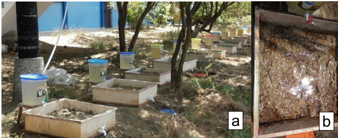
Figura 1. Ensayo de biorremediación de suelo de manglar contaminado con petróleo. a) Disposición de los cajones conteniendo el sustrato contaminado con petróleo, se aprecia los baldes para abastecimiento y recojo del agua, b) Vista del sustrato húmedo contenido en uno de los cajones.
