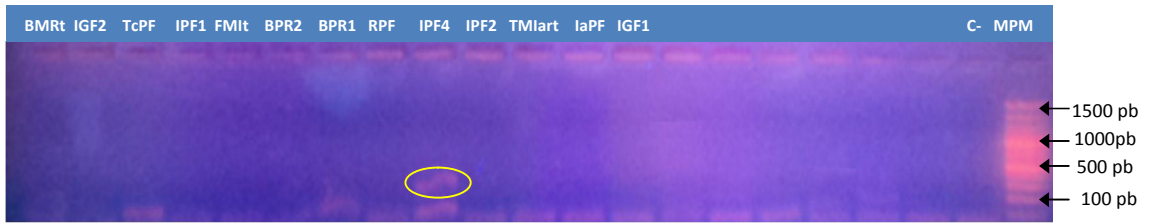
Figura 5. Producto de PCR amplificado con los iniciadores específicos del gen bi-fenil di-oxigenasa en las cepas aisladas. Se observa una banda fluorescente con un tamaño aproximado de 200 pb correspondiente a la cepa IPF4
